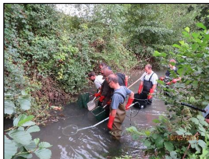
Figure 10 : Vue d'une pêche avec les porteurs d'anode, d'épuisettes et de la poubelle pour collecter les poissons (© FDAAPPMA77)
