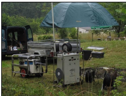
Figure 9 : Matériel de pêches électriques, au premier plan, à gauche, le groupe électrogène et à droite le boîtier servant à fournir le courant redressé (© FDAAPPMA77)
