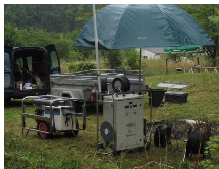
Figure 4 : Matériel de pêches électriques, au premier plan, à gauche, le groupe électrogène et à droite le boîtier servant à fournir le courant redressé (© Fédération de Seine-et-Marne pour la Pêche et la Protection du Milieu Aquatique).
