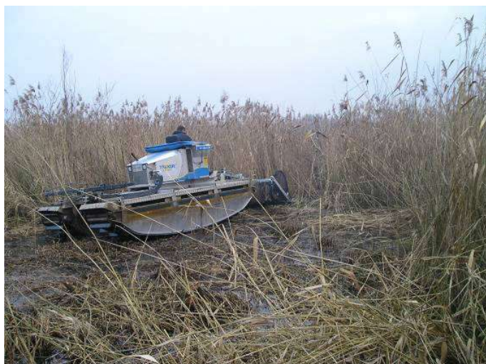
Figure 3 : Le « Truxor » est un engin amphibie qui permet la fauche des roseaux sans compacter les rhizomes (Source : AEV, 2010)
