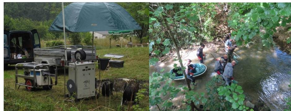
Figure 12 : Matériel de pêche électrique, au premier plan, à gauche, le groupe électrogène et à droite le boîtier servant à fournir le courant redressé (© Fédération de Seine-et-Marne pour la Pêche et la Protection du Milieu Aquatique).
