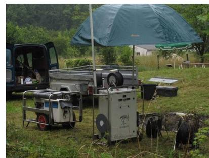
Figure 12 : Matériel de pêches électriques, au premier plan, à gauche, le groupe électrogène et à droite le boîtier servant à fournir le courant redressé (© Fédération de Seine-et-Marne pour la Pêche et la Protection du Milieu Aquatique).
