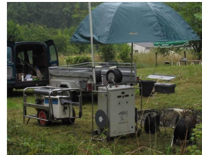
Figure 12 : Matériel de pêche électrique, au premier plan, à gauche, le groupe électrogène et à droite le boîtier servant à fournir le courant redressé (© Fédération de Seine-et-Marne pour la Pêche et la Protection du Milieu Aquatique).
