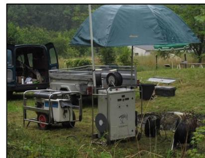
Figure 11 : Matériel de pêches électriques, au premier plan, à gauche, le groupe électrogène et à droite le boîtier servant à fournir le courant redressé (© Fédération de Seine-et-Marne pour la Pêche et la Protection du Milieu Aquatique)
