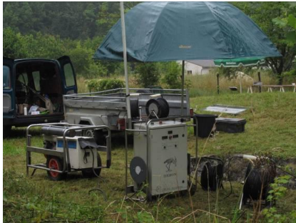
Figure 11 : Matériel de pêches électriques, au premier plan, à gauche, le groupe électrogène et à droite le boîtier servant à fournir le courant redressé (© Fédération de Seine-et-Marne pour la Pêche et la Protection du Milieu Aquatique)
