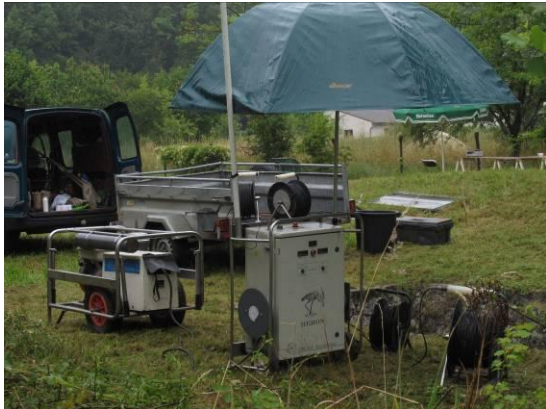
Figure 29 : Matériel de pêche électrique (premier plan) : groupe électrogène (à gauche) et boîtier servant à fournir le courant redressé (à droite) (© Fédération de Seine-et-Marne pour la Pêche et la Protection du Milieu aquatique)
